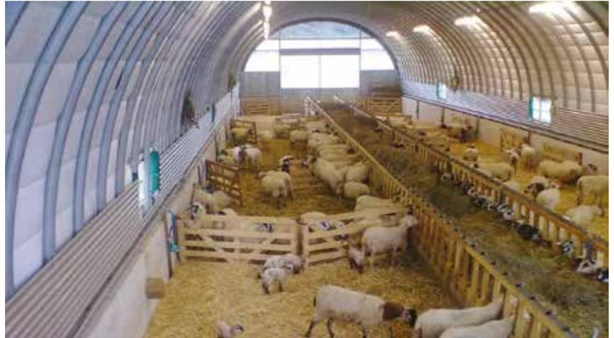
✓ Les cases sont sur aires paillées. Auges trottoirs bétonnées de 1,70 m par 32,5 m, cornadis des deux côtés. Le curage des cases est mécanisable.
